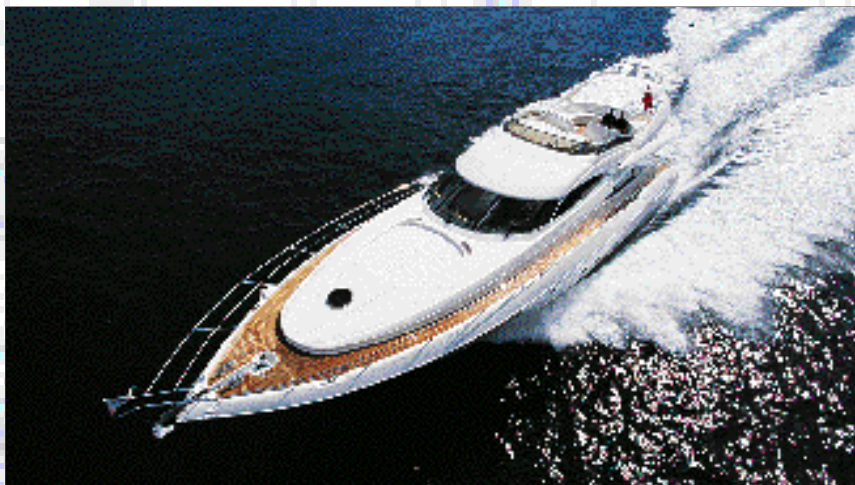
Etrave totalement dégagée, spray latéral très en arrière, telles sont les caractéristiques directement visibles d'une carène planante.
