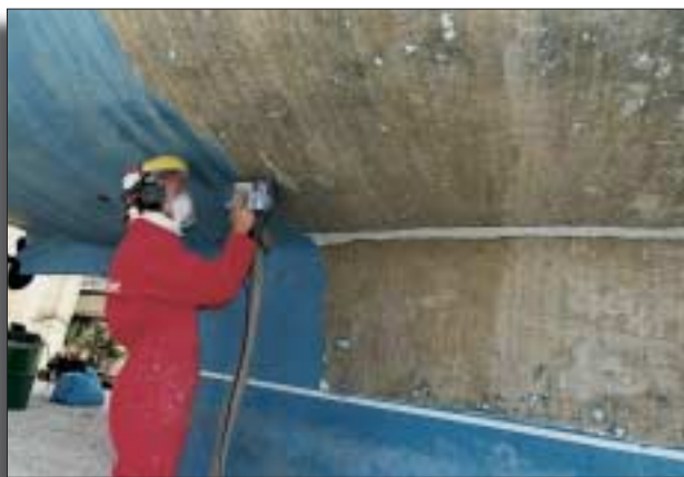
Le pelage de la coque permet d'obtenir une coupe uniforme du gelcoat et du stratifié.
