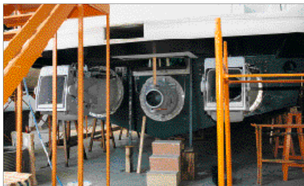
2 waterjets directionnels et 1 waterjet fixe de puissance au centre.
