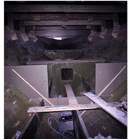
Le cloisonnement par sandwich avec âme mousse favorise l'isolation thermique et phonique.
