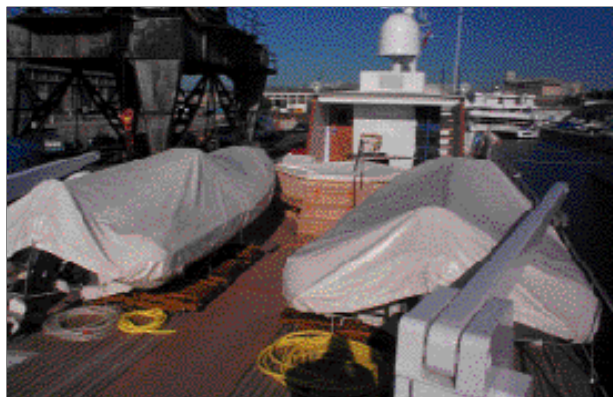
Les tenders et autres embarcations placés sur un pont supérieur influencent la stabilité d'un yacht.
